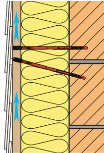
Hinterlüftete Fassadenbekleidung mit Dämmung (gelb) und Fachwerkverschraubung
