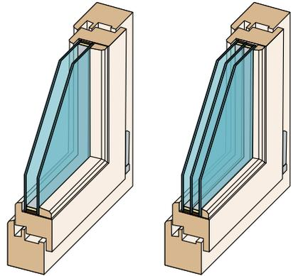
*Links: 2-fach-Verglasungen mit einer oder zwei Wärmeschutzbeschichtungen (nach Vorschrift)
